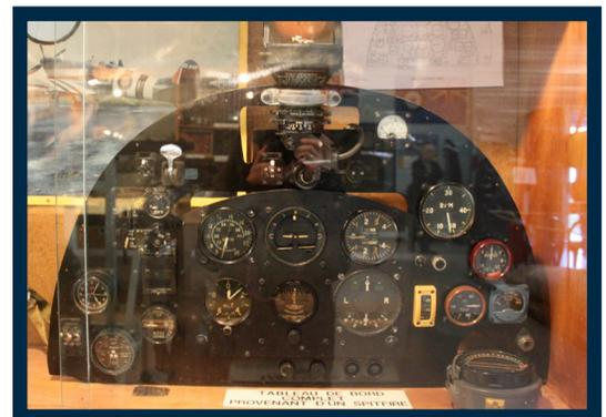
Les instruments de bord, indicateurs de paramètres indispensables au pilotage et à la sécurité des vols, sont placés sur le tableau de bord dans le poste de pilotage de manière rationnelle et ergonomique pour que les pilotes puissent facilement trouver toutes les informations dont ils ont besoin. Selon le type d'aéronef et le nombre de membres d'équipage, les instruments sont regroupés sur des tableaux et, pour le pilote, sur le tableau de bord situé devant lui.
